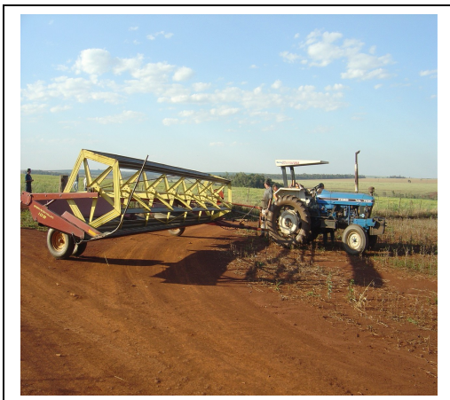
Figura 8. Equipamento para corte-enleiramento de canola (e cereais), fabricado no Canadá, acionado pela tomada de força de trator e com o levante do molinete acionado por hidráulico (as mesmas duas tubulações empregadas no levante hidráulico de semeadoras).
