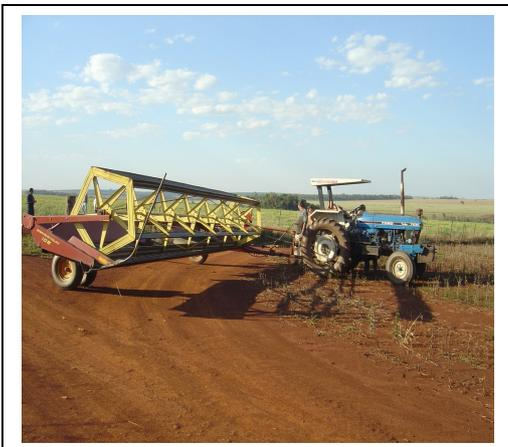
**Figura 8.** Equipamento para corte-enleiramento de canola (e cereais), fabricado no Canadá, acionado pela tomada de força de trator e com o levante do molinete acionado por hidráulico (as mesmas duas tubulações empregadas no levante hidráulico de semeadoras).
